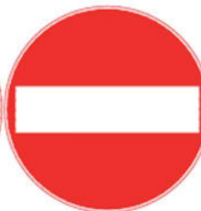
(TT-4) Girişi Olmayan Yol
